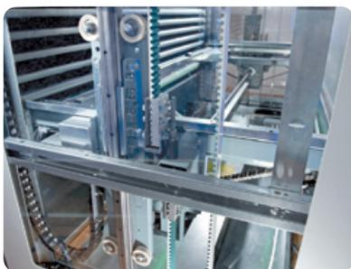
Der Extraktor transportiert das Tablar mit einstellbarer Geschwindigkeit zur Entnahmeöffnung bzw. zum Lagerplatz.
