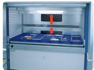
Automatische Hubtüren schützen Bediener, Lagergut und Maschine und verringern die Geräuschemissionen.
