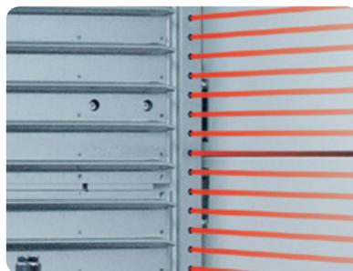
Das Höhenmessgitter ermittelt bei jedem Verfahrensvorgang die aktuelle Füllhöhe des Lagerguts im Tablar.
