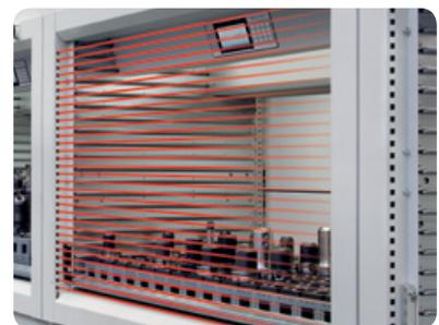
Die integrierte Sicherheitslichtschranke schützt bei Bedienfehlern das Personal vor folgenschweren Arbeitsunfällen.
