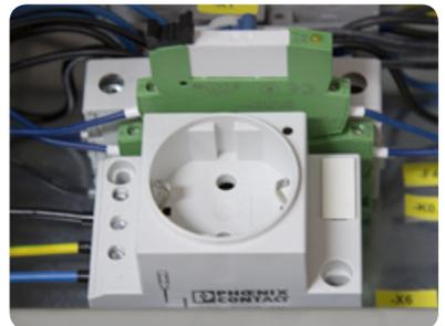
Die in der Steuerschublade eingebaute Steckdose für einfachen Zugang zum Stromnetz für Service- und Zusatzgeräte
