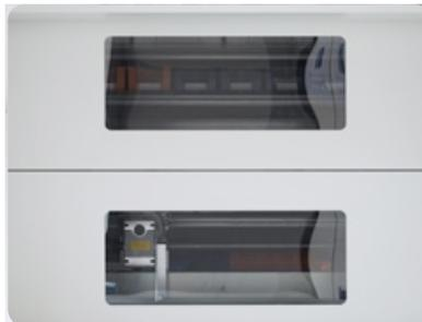
Sichtfenster an den Hubtüren für die Kontrolle von Tablar und Extraktor während des Verfahrenvorgangs
