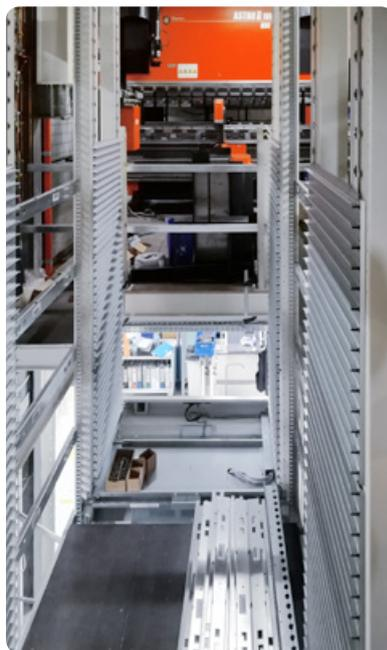
Da ein LTL Lagerturm sowohl auf der Vorder- wie auch auf der Rückseite mit insgesamt bis zu sechs Bedienöffnungen ausgestattet werden kann, ermöglicht er von verschiedenen Etagen aus den Zugriff auf das komplette Lagergut. So kann der Lagerturm in vielen Fällen einen kostspieligen und platzraubenden Lastenaufzug ersetzen.
