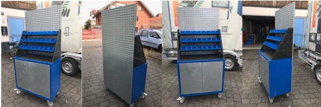
400 kg Traglast, 2 x Bockrollen, 2 x Lenkrollen mit Feststeller
