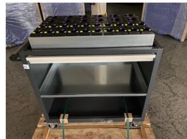
400 kg Traglast, 2 x Bockrollen, 2 x Lenkrollen mit Feststeller
