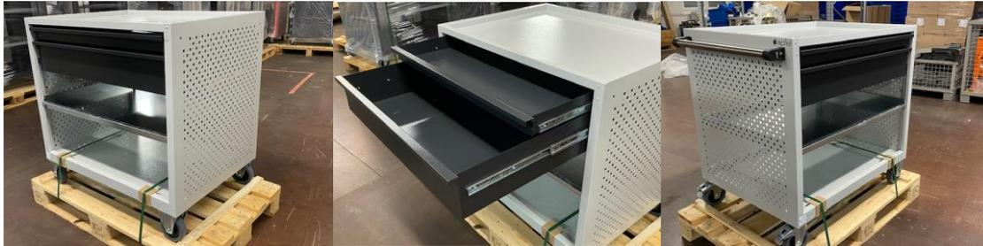
400 kg Traglast, Lochblechseitenwänden , 2 x Bockrollen, 2 x Lenkrollen mit Feststeller
