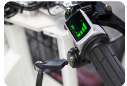
Schlüsselschalter und Ladestandsanzeige
