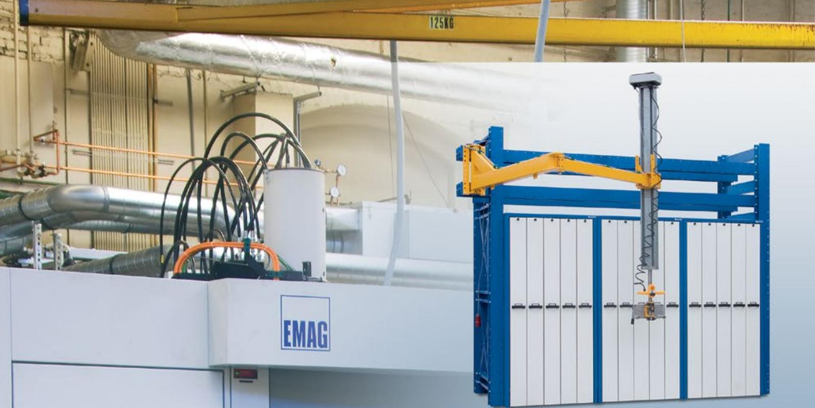
Lagerungssystem für Räumnadeln mit schwenkbarer Hebevorrichtung
