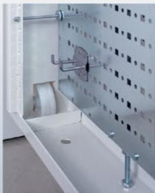
Unsere Lochblechwände sind komplett beidseitig nutzbar, per Rändelschraube horizontal stufenlos verstellbar und mittels Schrauben vertikal auszurichten. Sie verfügen allesamt über eine Quadratlochung von 10 x 10 mm sowie eine Rundlochung von 5 mm (der Abstand von Lochmitte zu Lochmitte beträgt 38 mm horizontal und vertikal).
