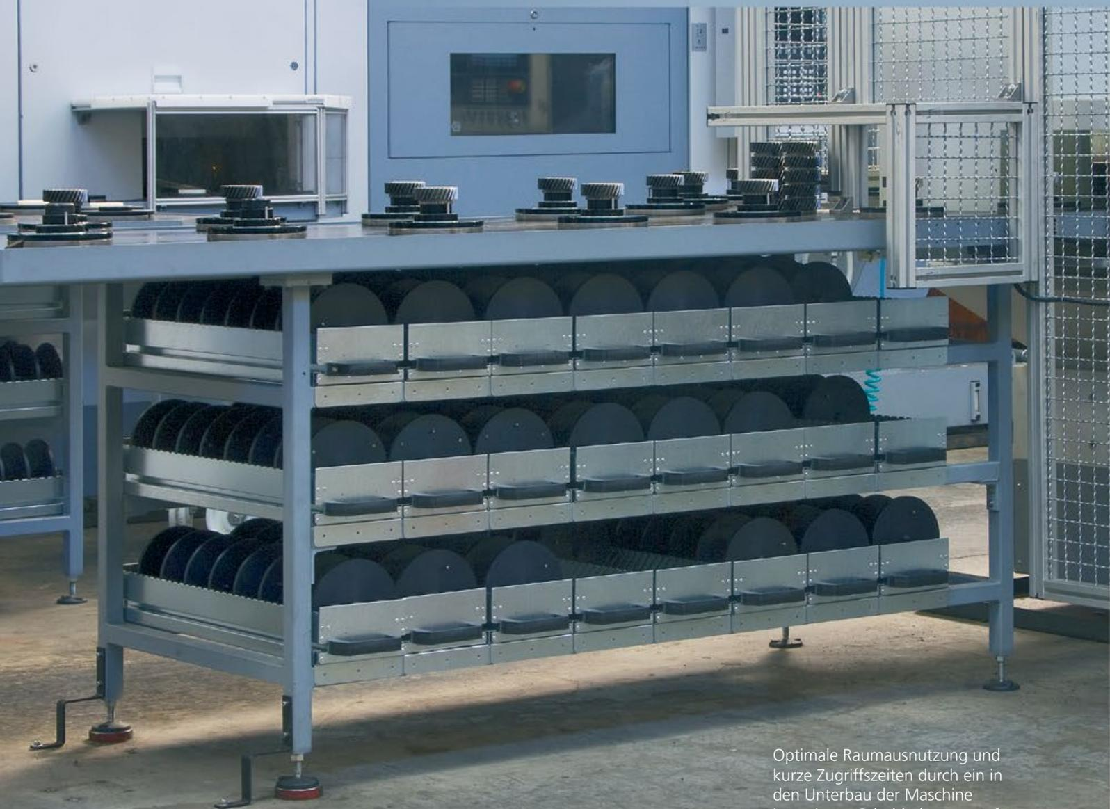
Optimale Raumausnutzung und kurze Zugriffszeiten durch ein in den Unterbau der Maschine integriertes Schubladensystem für die Lagerung von Zentrierplatten
