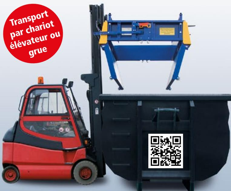
Grâce au fond relevable vous pouvez facilement décharger vos squelettes de poinçonnage dans le conteneur des déchets métalliques avec l'élevateur.
