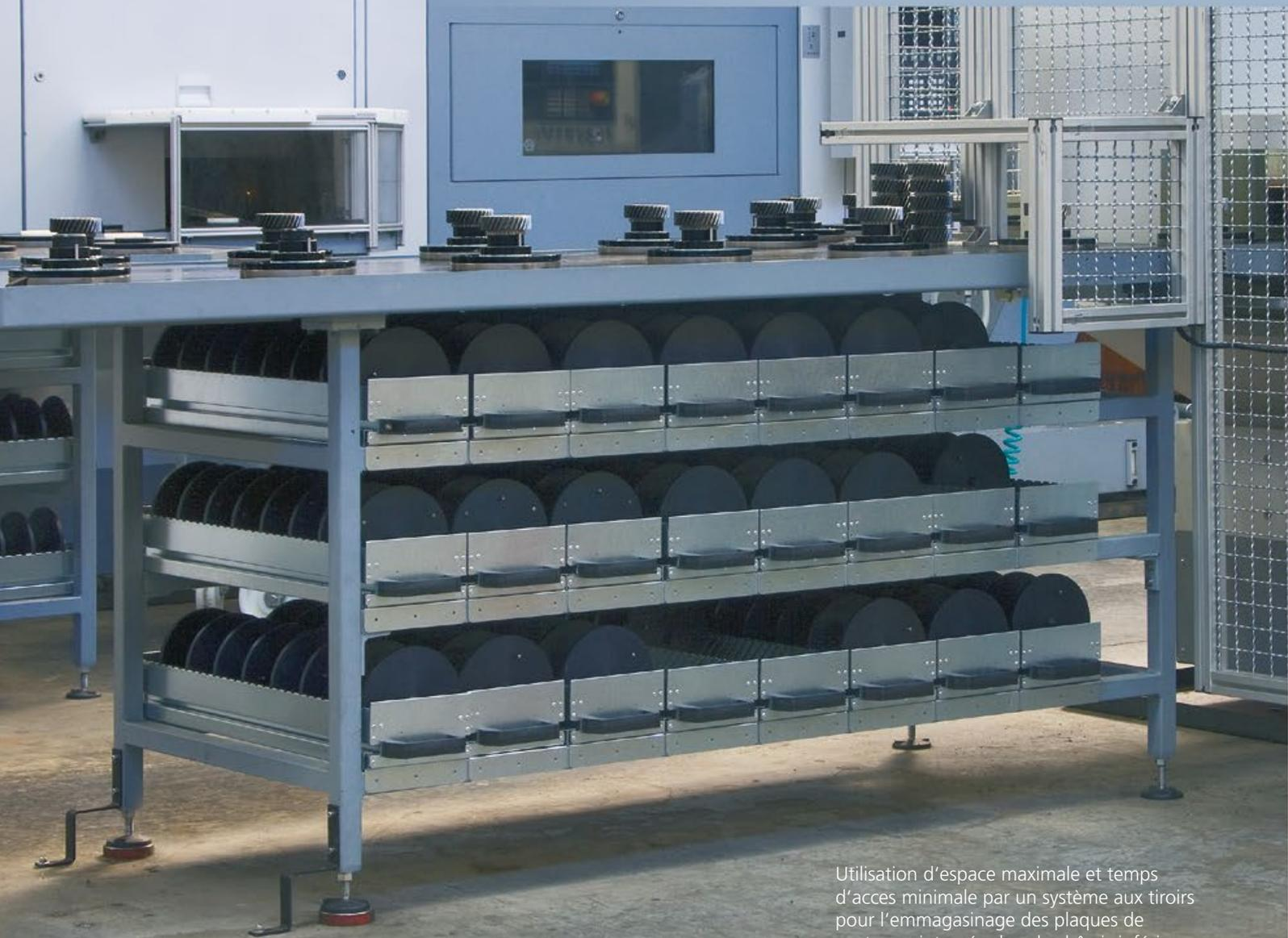
Utilisation d'espace maximale et temps d'accès minimale par un système aux tiroirs pour l'emmagasinage des plaques de centrage, intégrée dans le châssis inférieur de la machine de traitement
