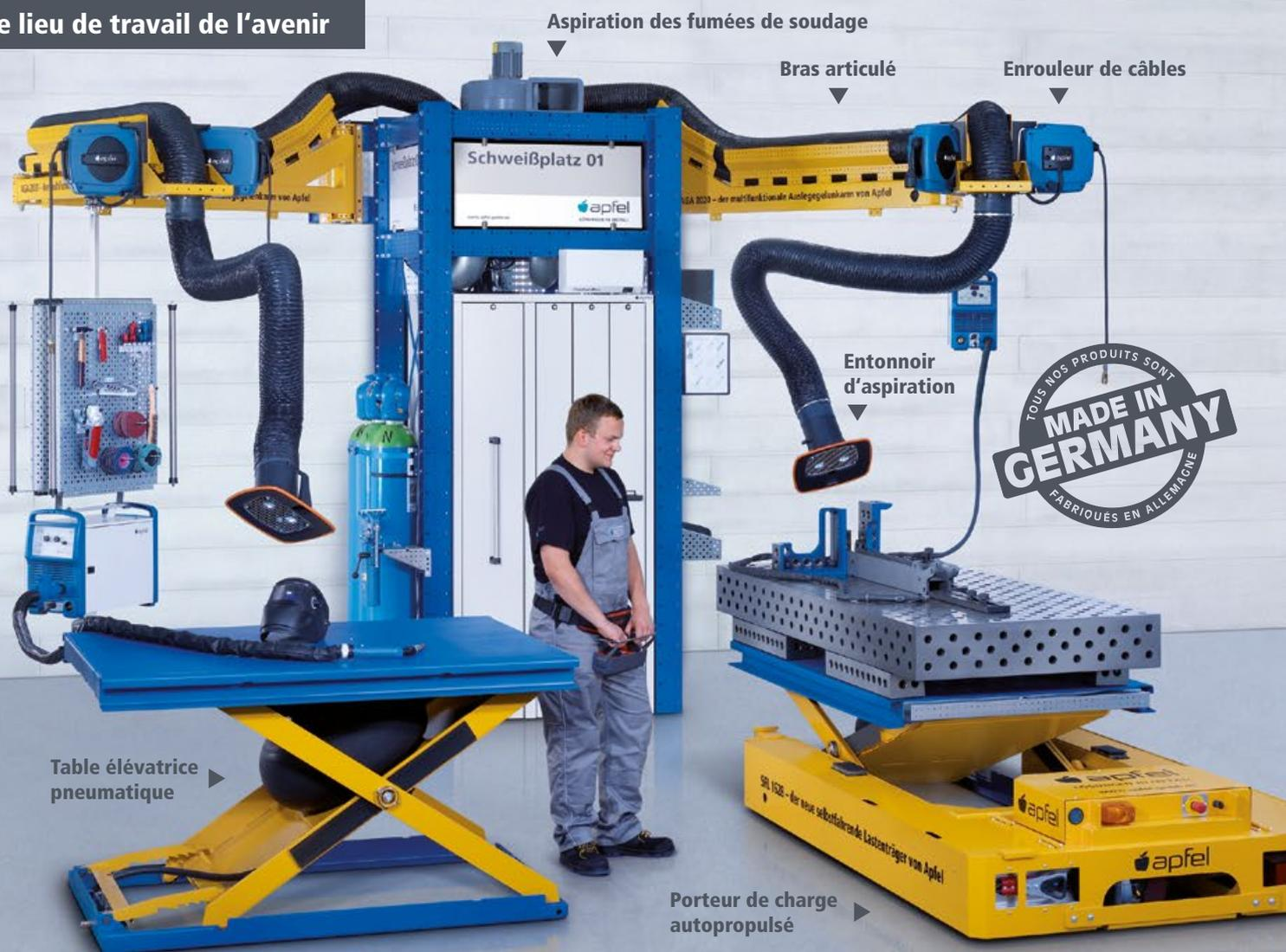
Entrez dans une nouvelle ère d'équipement industriel avec le concept de poste de travail multifonctionnel de Apfel qui augmente avec sa technologie innovatif l'efficacité, la propreté et surtout la sécurité dans vos usines.
