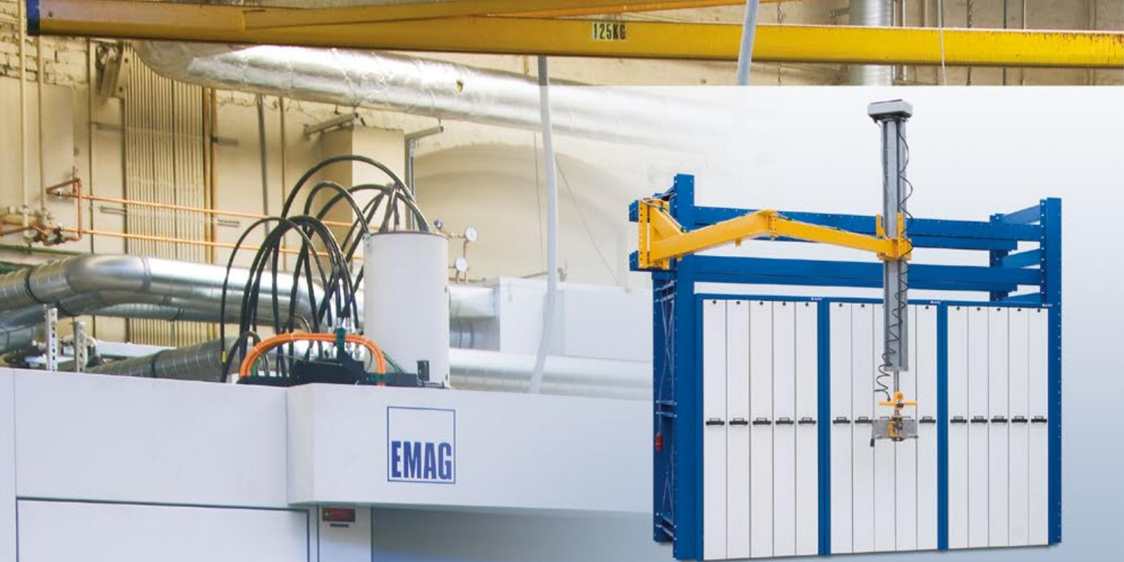
Système de stockage des outils de brochage avec dispositif de levage pivotable
