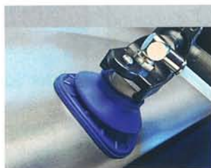
Sauggreifer aus NBR sorgen für hohe horizontale und vertikale Haltekräfte beim Handling dünnwandiger Karosseriebleche.
