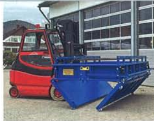
Durch Absetzen der Schrottbox auf dem Boden fahren die Bodenklappen mittels angebrachter Rollen vollständig zusammen.
