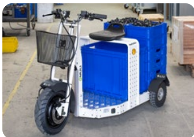
Ladefläche mit optimalem Maß zum Transport von Euronorm-Behältern
